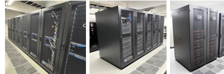
運用中のスーパーコンピュータ Grand Chariot 2 左：CPUノード群 中：GPUノード群 右：オールSSDストレージ
